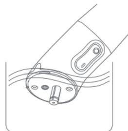
Upewnij się, że komora baterii jest zamknięta. Po odłączeniu górnej części zanurz otwór ssący (h) w wodzie i włącz aspirator. Maszyna wyczyści się w ciągu kilku sekund. Nie zanurzaj przełącznika.
